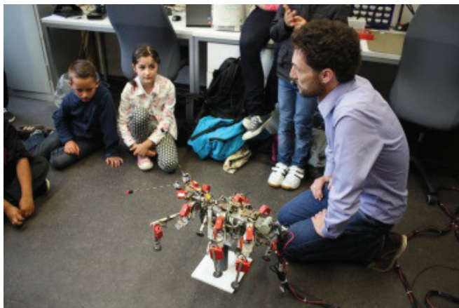
Labor der Bio-Kybernetik - Entwicklung eines Roboters: Als Vorbild dienten die Laufeigenschaften von Stabheuschrecken.
